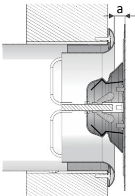
a = distanza regolabile della piastra frontale in vetro dal corpo della valvola con possibilità di regolazione del flusso
