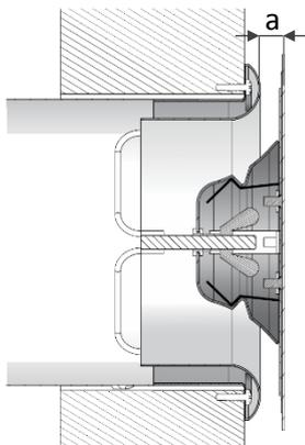
a= distanza regolabile della piastra frontale in vetro dal corpo della valvola con possibilità di regolazione del flusso
